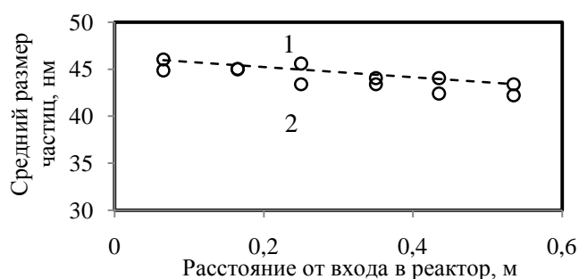
Рисунок 8 — Зависимость среднего размера наночастиц вольфрама от расположения зоны осаждения при различной длительности процесса. 1 — 10 мин, 2 — 60 мин.
